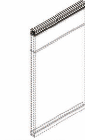
顶梁连接系统 Top bar connection
